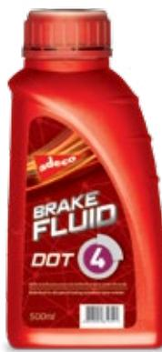
Kočiona tečnost, namenjena za hidraulične kočione sisteme motornih vozila, poljoprivredne i građevinske mehanizacije kod kojih se zahteva visoka pouzdanost. Preporučuje se za disk kočnice, kao i za doboš kočione sisteme. Obezbeđuje potpunu stabilitet u širokom temperaturnom intervalu od -40°C do 100°C. Omogućava visoke temperature ključanja preko 260°C. Ne sme se mešati sa mineralnim uljima. Preporučuje se interval zamene do dve godine.
