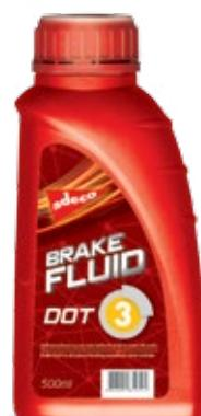
Kočiona tečnost, namenjena za hidraulične kočione sisteme motornih vozila, poljoprivredne i građevinske mehanizacije kod kojih se zahteva visoka pouzdanost. Preporučuje se za disk kočnice, kao i za doboš kočione sisteme. Obezbeđuje potpunu stabilitet u širokom temperaturnom intervalu od -40°C do 100°C. Omogućava visoke temperature ključanja preko 220°C. Ne sme se mešati sa mineralnim uljima. Preporučuje se interval zamene do dve godine.
