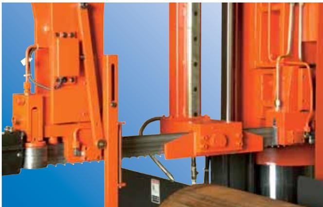
Zusätzlicher Bandführungsarm zur Anschnittstabilisierung
