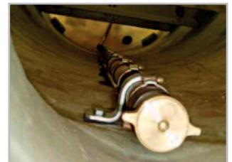
die Druckluftmisch-einrichtung homogenisiert die Gülle optimal
