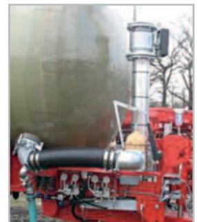
mittels Bypass wird die Ausbringmenge gesteuert und gleichzeitig die Gülle gemischt
