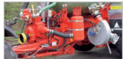
durch Turbo-Befüller wird die Befüllzeit wesentlich verkürzt
