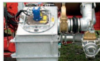
Steinfangkasten und Rota Cut zum Schutz der Pumpe vor Fremdkörpern
