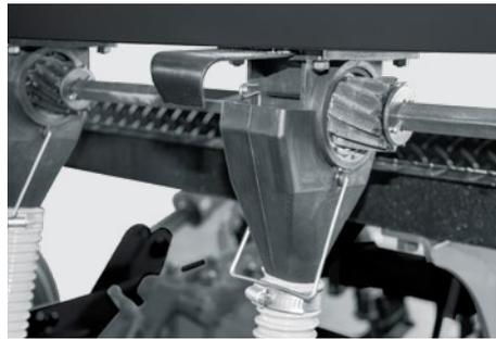
Sistema de distribuição de sementes por rotores helicoidais.
