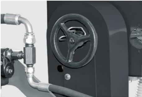
Volante que permite a regulagem do rotor, possibilitando maior variação na distribuição de semente e adubo.
