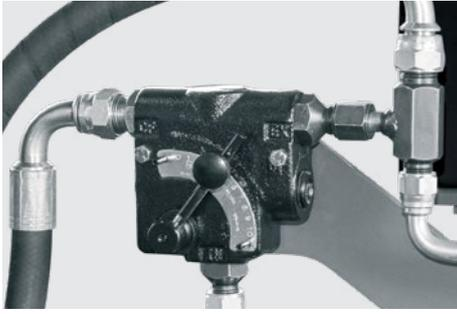
Válvula dosadora do fluxo de óleo para regulagem da distribuição de adubo e semente.
