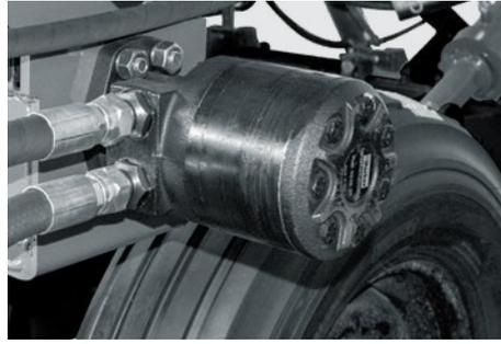
Motor hidráulico para acionamento da transmissão.
