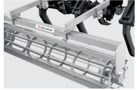
Rolo destorroador tem a função de pré-nivelar o solo para futuras operações.
