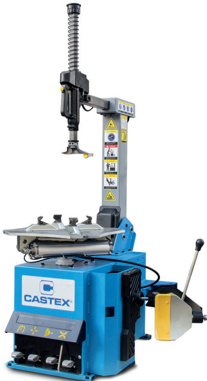
Demontowalny panel z pedałami sterującymi Removable panel with control pedals
