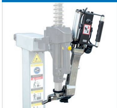
Inflator z węzłem do montażownicy CAM127 Inflator with a hose CAM127
