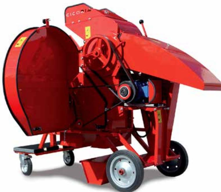
Dotata di variatore di velocità che consente di ottenere i giri del battitore più adatti ad ogni singolo prodotto da trebbiare.
