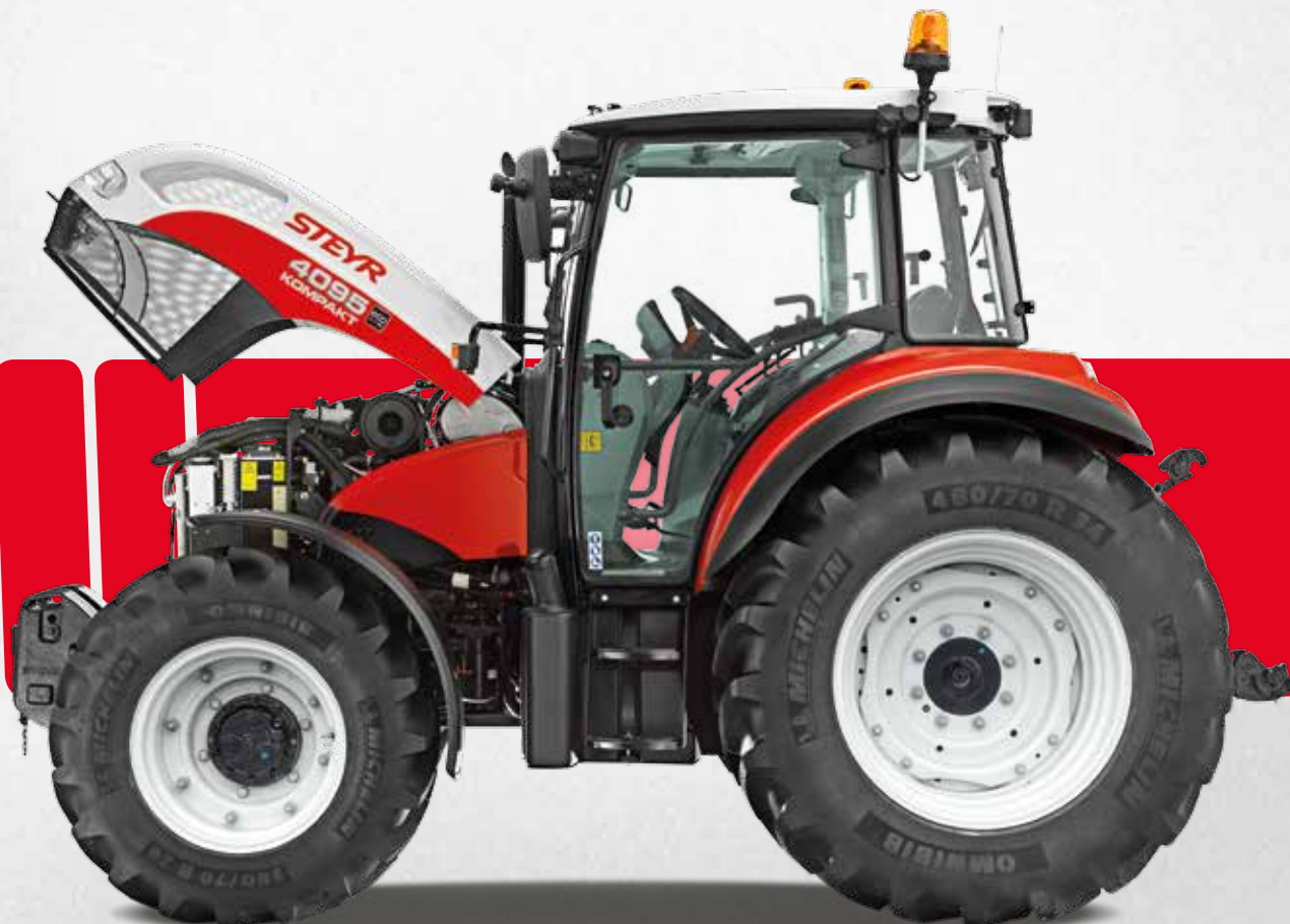
Grazie alla pulizia continua garantita da un filtro a ciclone, il filtro viene sottoposto a manutenzione solo quando segnalato dalla relativa spia.
