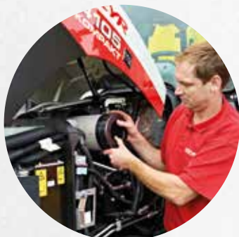
Grazie alla pulizia continua garantita da un filtro a ciclone, il filtro viene sottoposto a manutenzione solo quando segnalato dalla relativa spia.
