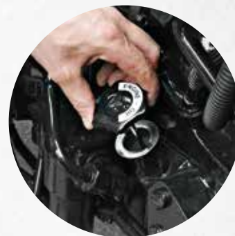
Controllo del livello dell'olio e rabbocco senza sollevare il cofano del motore.
