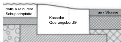
Système Kasseler Querungsbord® avec surface anti-glissement posé à niveau 0. Kasseler Querungsbord® mit Nullabsenkung und rutschhemmend genoppter Oberfläche.
