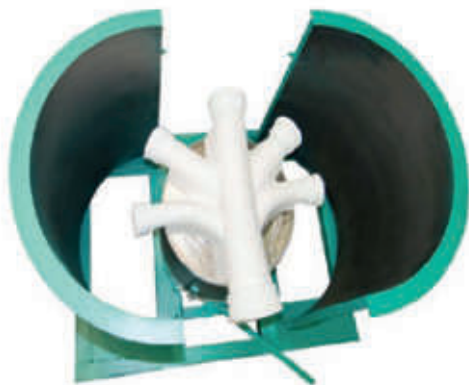
Moule négatif fraisé dans le coffrage ouvert Gefräste Negativform in geöffneter Schalung
