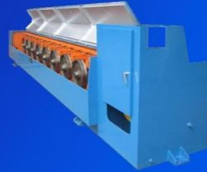
Tel çekme,uzatma,inceltme makinası Wire drawing, stretching, thinning machine
