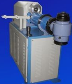
Toplama –Sarma – Kangallama makinası Take-up / coiling / wrapping machine
