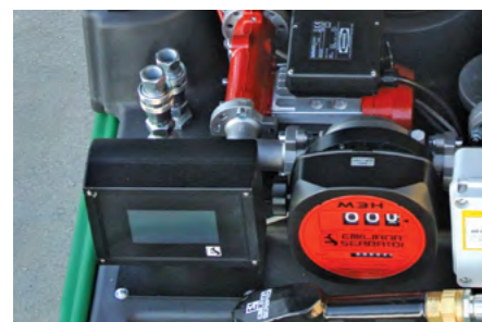
Il dispositivo Emilprobe®, il contaltri meccanico e i raccordi rapidi per la versione GE. Emilprobe® alarm system, mechanical flow meter and, on left, quick couplings for GE version.
