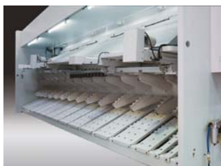
Pneumatik-Blechunter- stützung, Typ D (optional) / Pneumatic sheet support, type D (optional)
