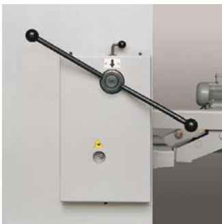
Manuelle Glade Lücke Einstellung (Standard) / Manual blade gap adjustment (standard)
