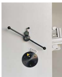
Manuelle Klingenlückenverstellung (Standard) / Manual blade gap adjustment (standard)
