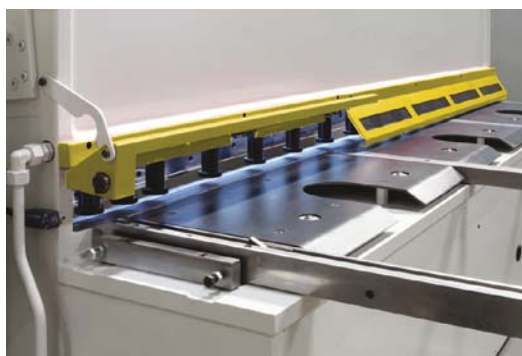
1000 mm anhebender vorderer Fingerschutz mit elektrisch verriegelbarer Sicherheitsschalter / 1000 mm lift-up front finger guard with electrically interlocked safety switch
