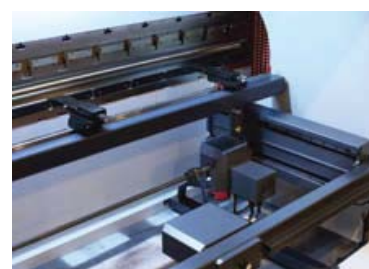
Zwei-Achsen Hinteranschlag (X-R) / Two axes backgauge (X-R)
