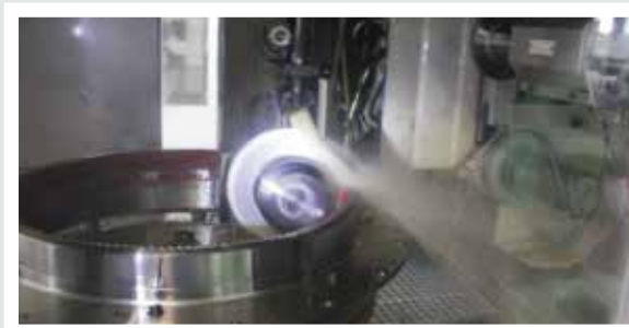
CNC Zahnprofilschleifmaschinen für Module bis 35 und 2500 mm Durchmesser
