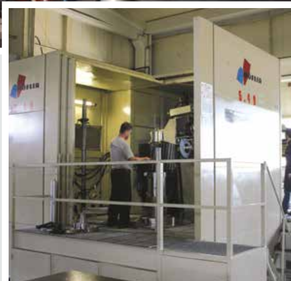
CNC Zahnprofilschleifmaschinen für Module bis 35 und 2500 mm Durchmesser
