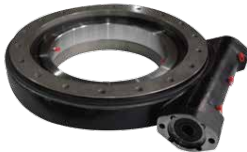
SCHWING GETRIEBE ER528 I: 1/102 DREHMOMENT NM 4500 KRAFT 0,47 KW
