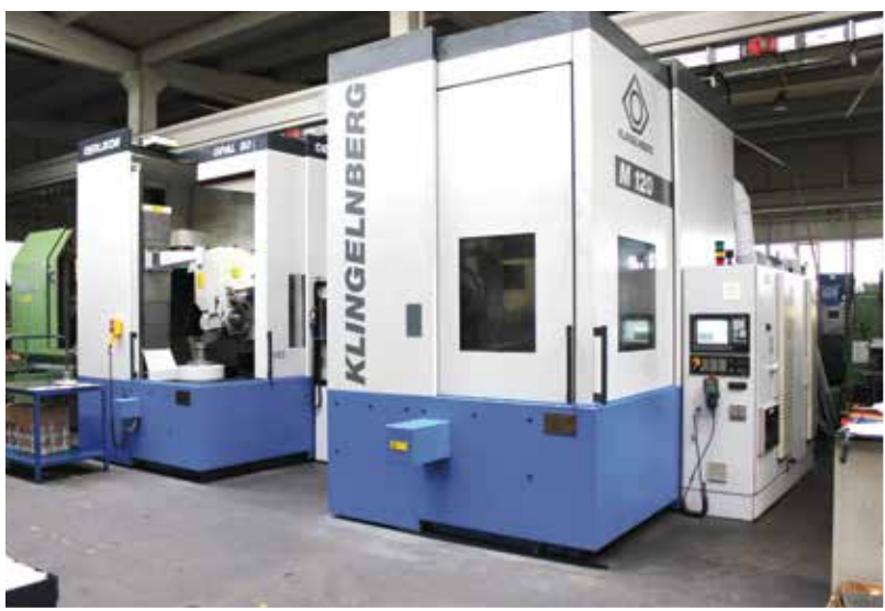
1200 mm CNC Zahnprofilschleife / CNC Profil Messung und Profilschleife für Innenzahn
