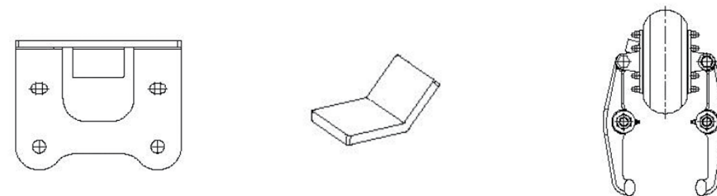
Kit correttore di sterzata standard con attacchi per corpo assale Air bellow kit for steering axles with fixing components Standardsatz Luftbalg mit Befestigungsteilen für Achskörper Kit correcteur de direction standard avec fixations pour corps axial
