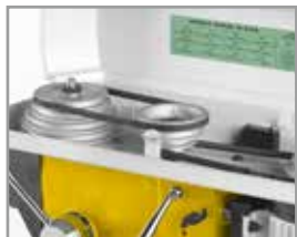
Coperchio superiore con microswitch di sicurezza Capot motore équipé d'un interrupteur à manque tension
