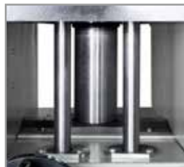
Piano di lavoro per piallatura a spessore montato su 3 guide per evitare basculamenti e rotazioni del piano
