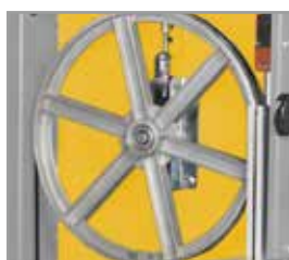
Diametro volani 354 mm ed indicatore di tensione lama
