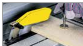
Carrello a squadrare con goniometro Chariot de sciage avec guide d'angle et presseur
