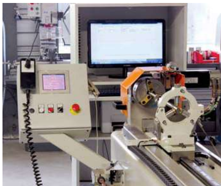
CONTRÔLE COUPLE DE ROTATION Vis à billes et roulements à billes Selon la norme ISO 3408-3
