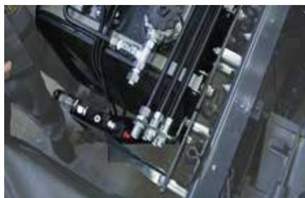
*Dauerhaft vor Korrosion geschützt: Kunststoffbeschichtete Stahlleitungen.*
