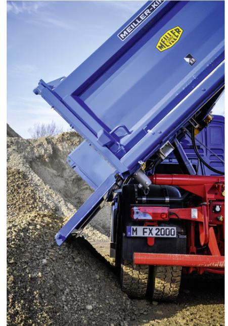
Bordmatik mit Abklappwinkel 90°: Das Schüttgut wird weit vom Fahrzeug weg abgeladen.
