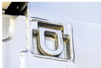
Schwenkbare Zurrösen in der Stirnwand halten das Transportgut nach vorne.
