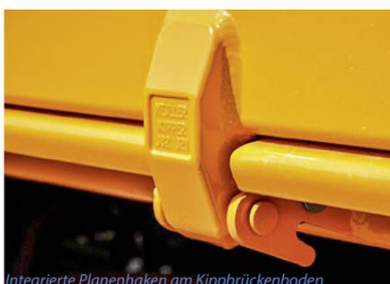
Integrierte Planenhaken am Kippbrückenboden
