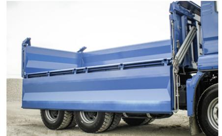
*Seitenwand pendelnd und abklappbar mit Federentlastung.*
