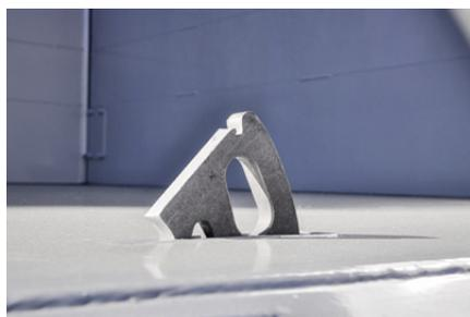
Versenkbare Zurrösen am Brückenboden: Kein Schüttgut bleibt haften.
