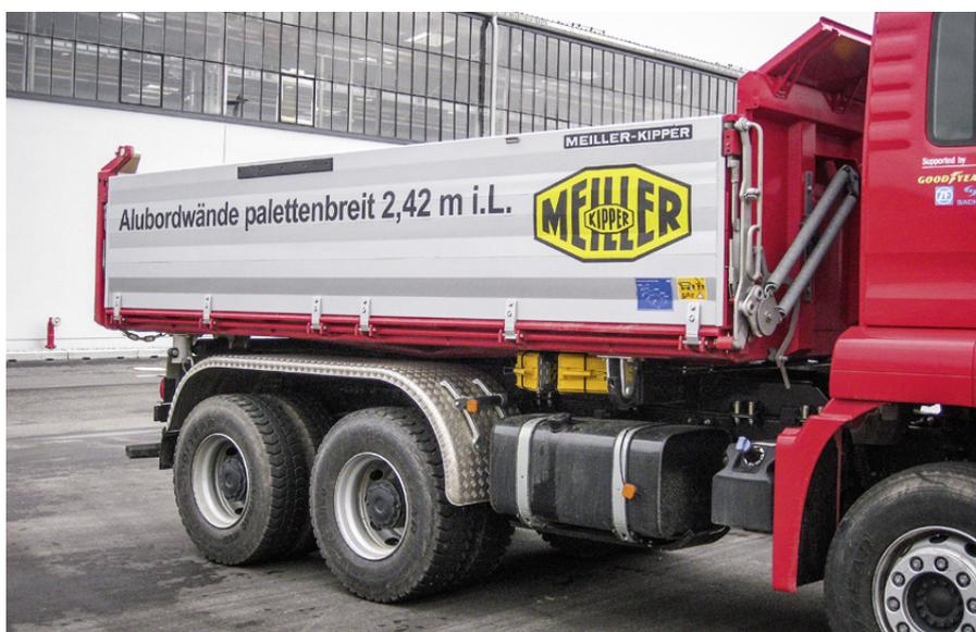
*Seitenwände aus Aluminium Hohlprofilen 63 mm reduzieren das Eigengewicht und vergrößern die Innenbreite auf 2,42 m. Damit transportieren Sie auch Europaletten.*
