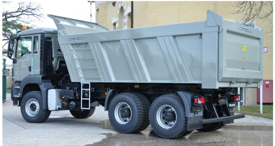
Schnell aufgestiegen: Seitlicher Aufstieg mit Aufstiegsleiter und Trittstufen.
