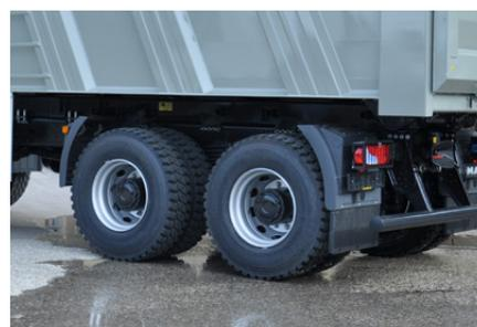
1/4-Schalenkotflügel aus Kunststoff
