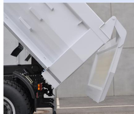
Erhöhte Rückwandlagerung ermöglicht einen großen Durchgang z.B. für schweren Abbruch.
