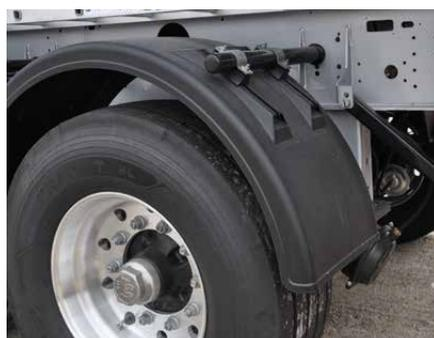
Stabile Halterungen für die Kotflügel sind beim Baustelleneinsatz unverzichtbar.
