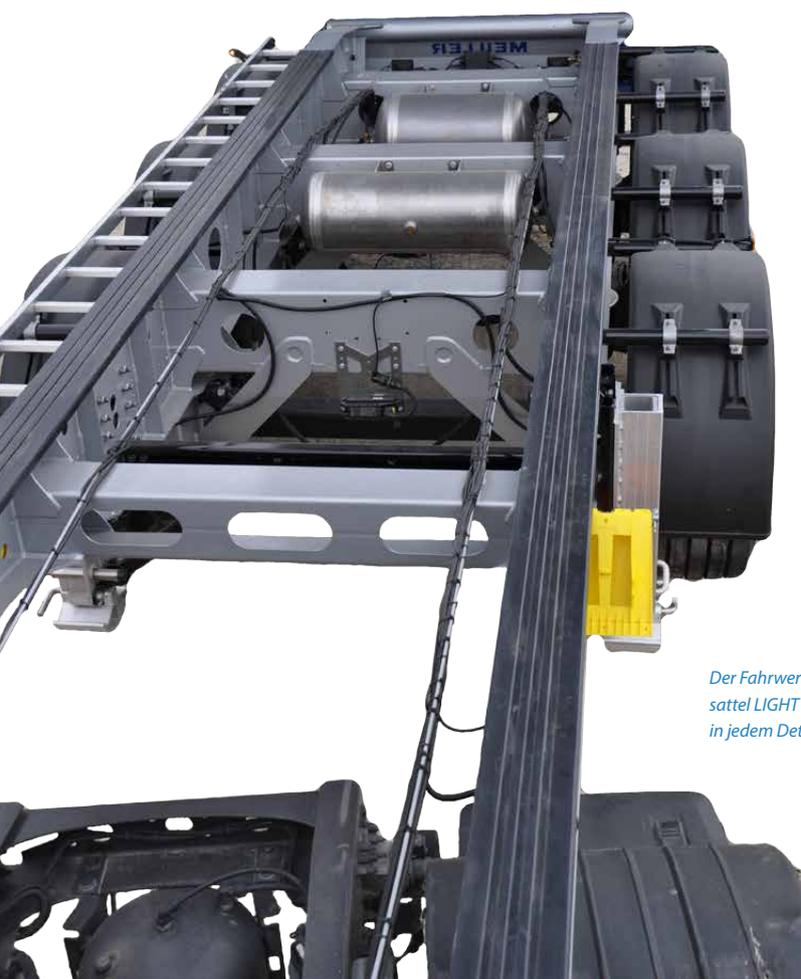
*Der Fahrwerkrahmen des Kippsattels LIGHT – gewichtsoptimiert in jedem Detail.*
