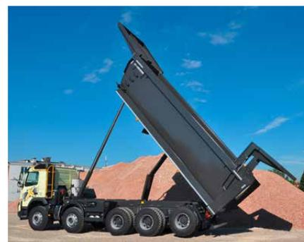
Erhöhte Rückwandlagerung ermöglicht einen großen Durchgang z.B. für schweren Abbruch.
