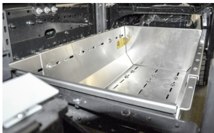
Raum optimal genutzt: Netzkästen zwischen den Achsen.
