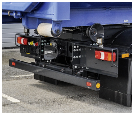
Unterfahrerschutz immer an der richtigen Stelle: beim Kippen und Abrollen eingeschoben, beim Fahren ausgezogen.
