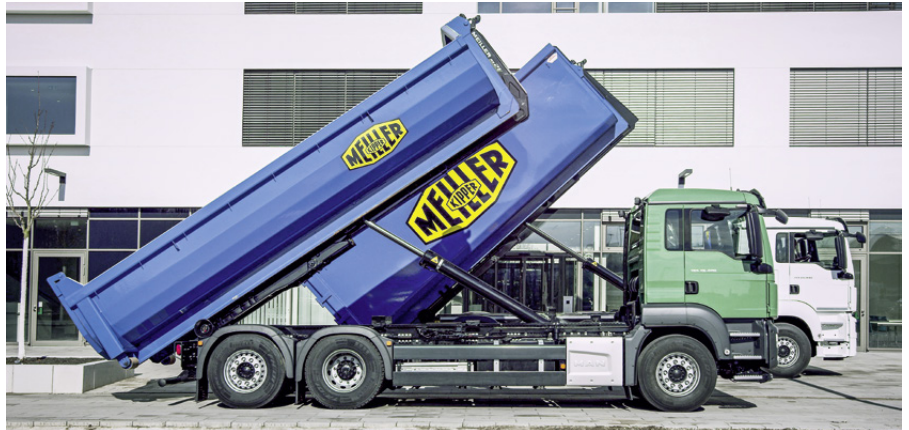
Kaum einzuholen: Der neue Abrollkipper senkt sich mit Effizienzpaket doppelt so schnell als sein Vorgänger.
