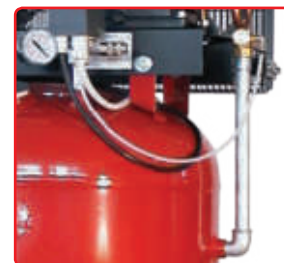
3 Tubo collegamento grandi dimensioni per miglior resa.
