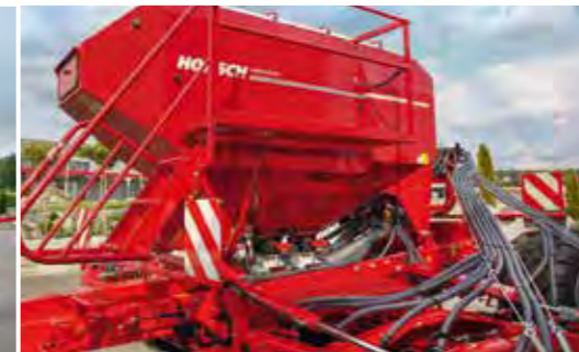
Double hopper 5 000 litre; partition 40 : 60
