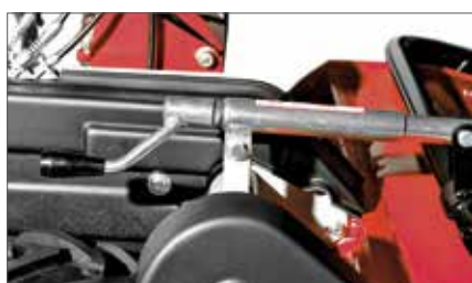
Regolazione altezza di taglio a vite
