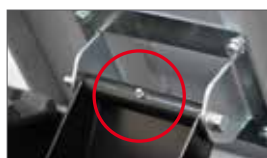
INGRASSATORE sul perno di rotazione del cassone.
