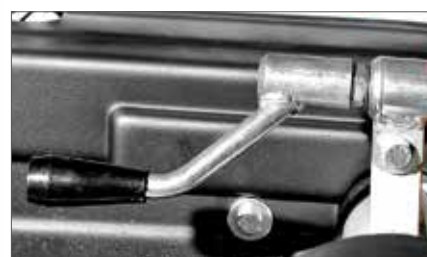
Regolazione altezza taglio a vite
