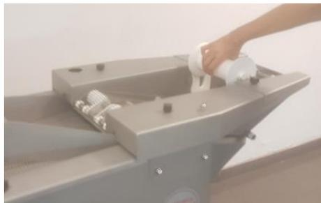
Foto 8, Desmontar rodillo inmersor
