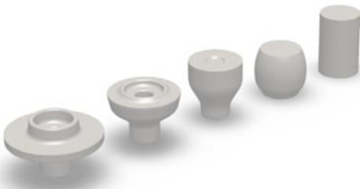
Линия автоматизированная для горячей штамповки на базе КГШП усилием 2500 тс предназначена для безоблойной штамповки круглых в плане поковок с вырубкой отверстия из стальных штучных заготовок.
