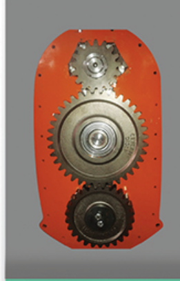
Yan hareket sistemine sahip dişli aktarma sistemi Digging feet
