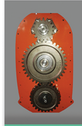
Yan hareket sistemine sahip dişli aktarma sistemi
