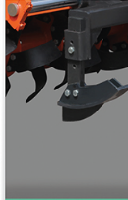
Seviye derinlik ayarı Level depth adjustment
