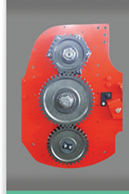
Yan hareket sistemine sahip dişli aktarma kısmı
