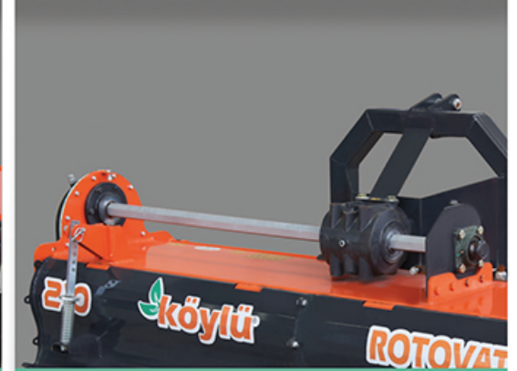
Mekanik kaydırma aparatı Mechanical shifting
