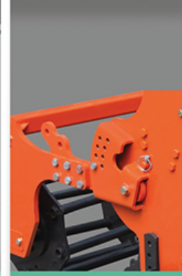
Merdane uzunluk ve derinlik ayarı Roller length and depth adjustment
