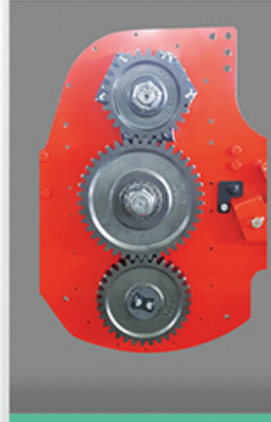
Yan hareket sistemine sahip dişli aktarma sistemi
