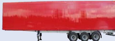
De CF-400 is gebaseerd op de CF-200. Het grote verschil tussen beide trailers is dat de CF-400 een doorlopend chassis heeft. Een trailer met deze specificatie wordt veelal ingezet voor werk onder zware omstandigheden, zoals bijvoorbeeld in de afvalsector.
