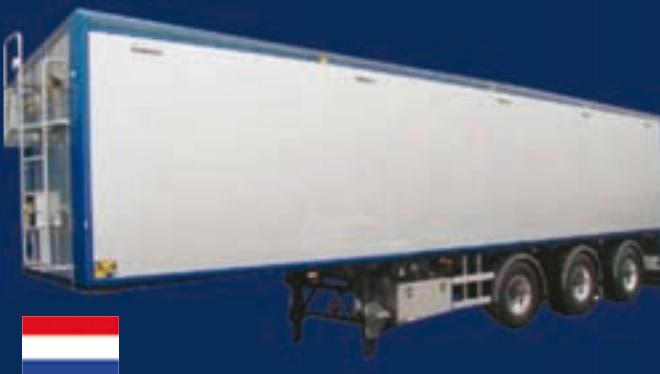
De CF-200 TD heeft één of twee stuurrassen. Door de toepassing van deze assen wordt een combinatie wendbaarder. Dit geeft een voordeel bij moeilijk bereikbare laad- en losplaatsen en bijvoorbeeld distributietransport.
