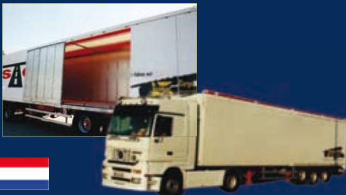
De CF-501 met zijdeuren van 6.2m. breed wordt ingezet voor het transport van ladingen die breder zijn dan 2.5m. of voor lange, ondeelbare ladingen. Een bijkomend voordeel is dat pallets snel via de zijdeuren kunnen worden geladen en gelost.
