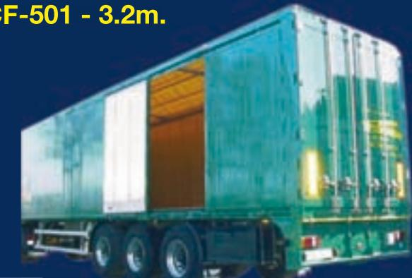
De CF-501 met zijdeuren van 3.2m. breed wordt ingezet voor het transport van ladingen die breder zijn dan 2.5m. of voor lange, ondeelbare ladingen. Een bijkomend voordeel is dat pallets snel via de zijdeuren kunnen worden geladen en gelost.
