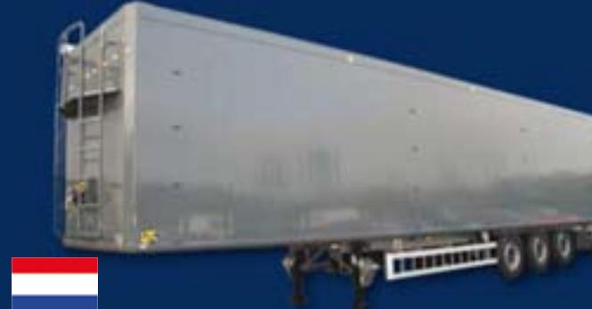
De CF-200 is de basis-schuifvloertrailer. Deze trailer kan met tal van opties en aanpassingen worden aangepast aan de wensen en toepassingen van de klant. De totale inhoud van deze trailer kan variëren van  $60\text{ m}^3$  tot  $102\text{ m}^3$  bij een lengte tussen  $10\text{m}$  en  $13\text{m}60$ .
