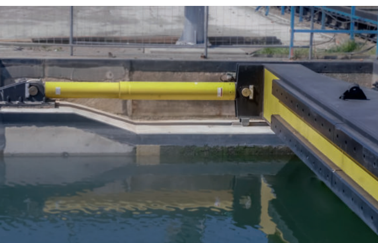
Dämpfung für Zugkupplung // Damping for train coupling
