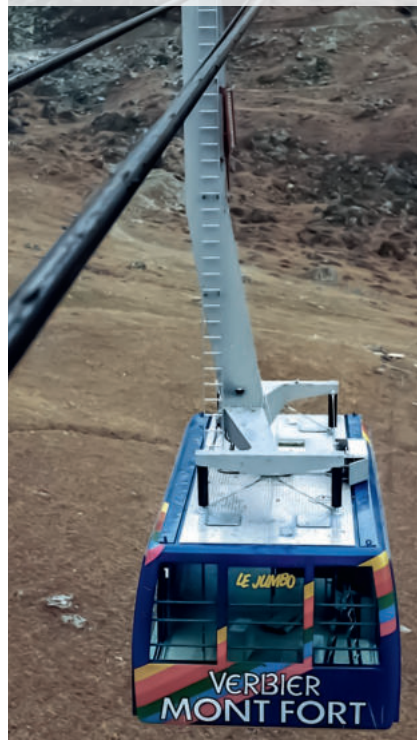
Seilbahnkabine mit Pendeldämpfung // Ropeway cabin with oscillating damping
