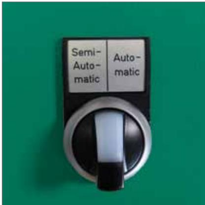
Mit der Auto-Start Funktion kann der Kompressor je nach Stellung des Wahlschalters im Automatik- oder im Halbautomatikmodus betrieben werden.
