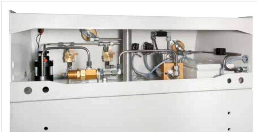
3-fach Sicherheitsfüllbox für zwei Druckbereiche - Rückansicht
