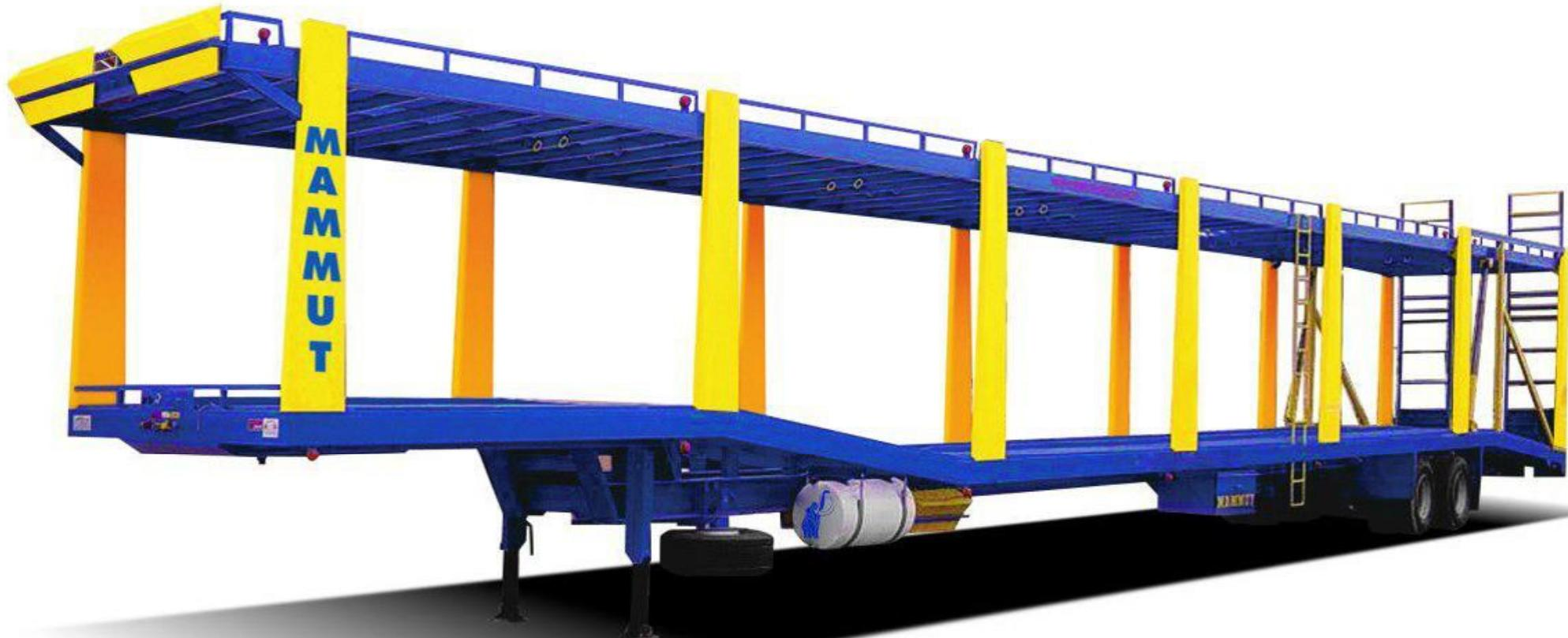
بارگیری خودرو ها به همراه قاب نگهدارنده آن - دو عدد نردبان فولادی به منظور دسترسی به کف بالای نصب شده بر ستون عقب - شانزده عدد دندۀ پنج فنری مخصوص جهت نگهداری چرخ سواری ها در هنگام حرکت - یک عدد محفظه کیسول آتش نشانی - دو عدد گل پخش کن عقب .
