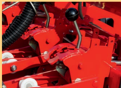
Réglage de la pression de l'élément. Element pressure adjustment.
