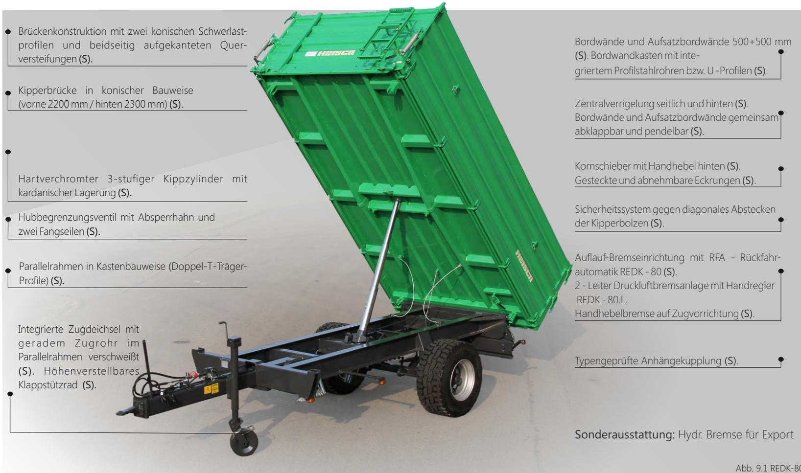
• Brückenkonstruktion mit zwei konischen Schwerlastprofilen und beidseitig aufgekanteten Querversteifungen (S).
