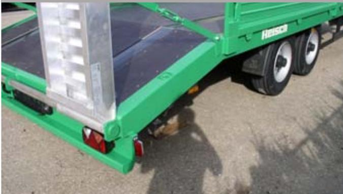
■ Tieflade-Plattform-Anhänger mit abgeschrägtem Fahrzeugheck.
