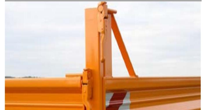
■ Erhöhte Pendellagerung für die Rückwand.
