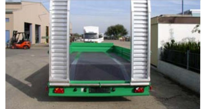
■ Tieflade-Plattformanhänger mit leichten, klappbaren Aluminium-Auffahrampen.
