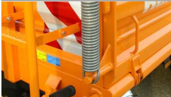
■ Beidseitige Federhilfe zum leichteren Öffnen und Schließen der Seitenbordwände.
