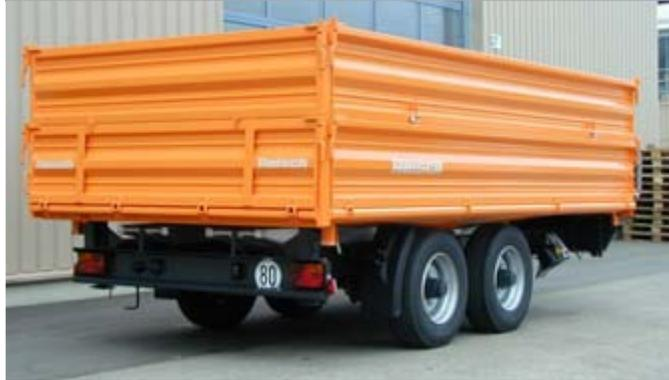
■ Tiefladeanhänger mit zusätzlichen Profilstahl-Aufsätzen.
