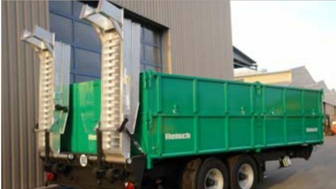
■ Tieflade-Anhänger für Volumentransporte mit Aluminiumbordwänden und Aluminium-Auffahrampen. Aufbaulänge ca. 6.000 mm.
