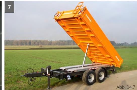
1 Automatische Anhängerkupplung, Durchleitung Hydraulik und Druckluftbremse für 2. Kipper, Einstellbares Drosselventil und Schnellwechselsystem für hydraulische Rückwand.
