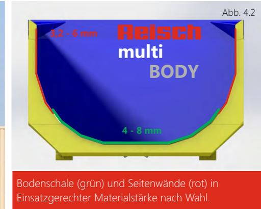
Bodenschale (grün) und Seitenwände (rot) in einsetzgerechter Materialstärke nach Wahl.
