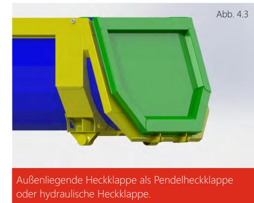
Außenliegende Heckklappe als Pendelheckklappe oder hydraulische Heckklappe.
