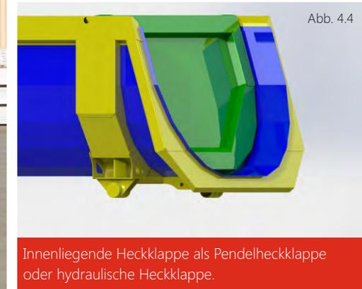
Innenliegende Heckklappe als Pendelheckklappe oder hydraulische Heckklappe.
