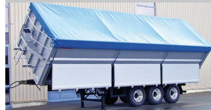
Großraummulde rückwärts und seitlich kippbar. Bordwände mit Zentralverschluss.
