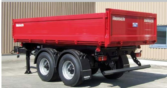
In zweiachsiger Bauweise mit Aluminium-Hohlprofilbordwänden. Optional: Stahlspanten-Bordwand, Bordmatik.
