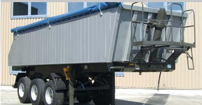
In Aluminium-Profilbauweise mit unterschiedlichen Bordwandhöhen.
