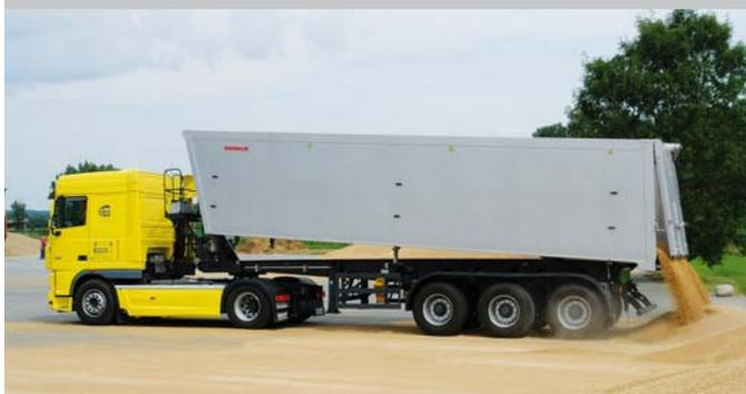
Großraummulde mit aufliegender Heckklappe.
