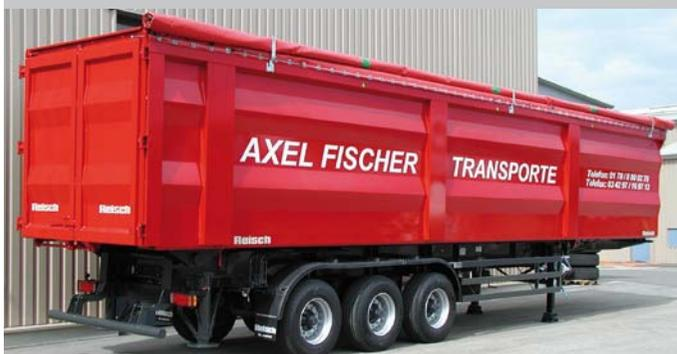
Stabile, gewichtsoptimierte Stahlschrottmulde in längsgesickter Bauweise.
