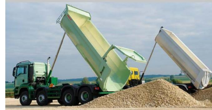
Hinterkippaufbauten in Alu- oder Stahlschalen-Bauweise für vierachsige LKW-Fahrgestelle.
