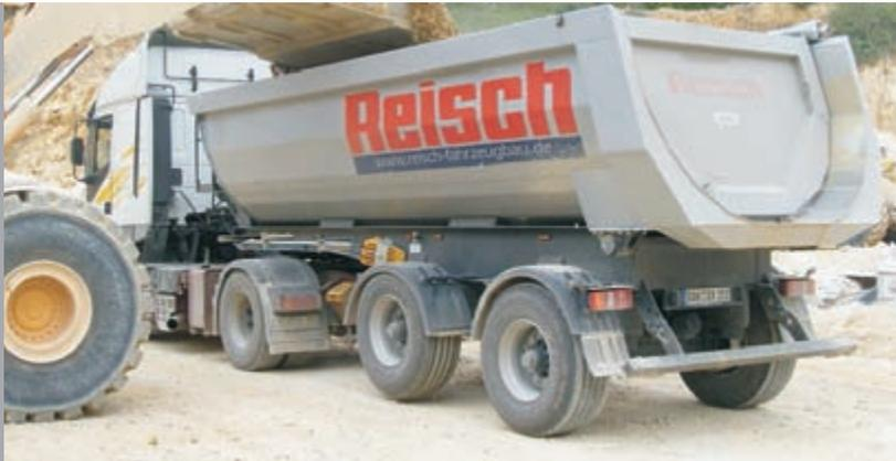
**Links: Kompakmulde mit Starrem Achsaggregat.**
