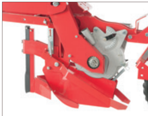
Falcione per massima profondità FUTURA Cutter maximum depth FUTURA
