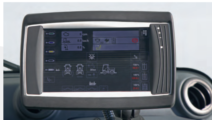
Touch-Display zur Bedienung sämtlicher Hydraulikfunktionen
