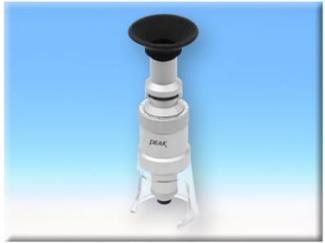
Alle Messmikroskope der Serie 2008 werden durch das koaxiale Drehen des Tubus fokussiert. Lieferbar sind die Vergrößerungen 25-, 50-, 75- und 100-fach. Das Okular lässt sich zur Skala fokussieren, die im Unterschied zur Serie 2034 nicht im Okular eingebaut ist. Die Messskala ist oberhalb des Tubus separat eingebaut und in einer
