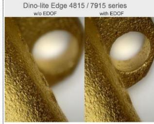
über die EDOF-Funktion können Bilder mit einer größeren Tiefenschärfe erstellt werden. Über ein Fotostacking werden mehrere Bilder vom Mikroskop gemacht und in der Software verrechnet. Das Ergebnis ist ein Bild mit einer größeren Tiefenschärfe.
