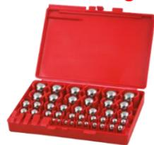
Stahl-Messkugeln im Satz um u.a. kegelige Bohrungen zu messen. Dieser Satz besteht aus einer Reihe Kugeln von verschiedenen Maßen, mit zwei Kugeln von jedem Maß.
