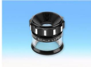
Die Messlupe 2016 ist eine Weitwinkellupe mit 15-facher Vergrößerung in Kombination mit einer Glasskala Teilung 0,1 mm. Um die scharfe Beobachtung des gesamten Felds von 20 mm Durchmesser bei einer 15-fachen Vergrößerung des Objekts zu ermöglichen, ist die Lupe neu entwickelt worden. Die Feldwölbung
