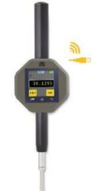
Messuhr mit 1 µm oder 0,1 µm Auflösung. Eingebauter Mikrocomputer mit 1,5" Bildschirm. Temperaturkompensation. Mathematische Fehlerkorrektur. Go-NoGo-Funktion. Speicher für bis zu 100 Messwerte. Wireless und USB Datenausgang auf Windows, Android und iOS bis zu 10m. Alle technischen Daten finden Sie auf unserer Homepage.
