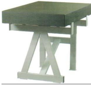
Preiswerte Gestelle in sehr stabiler Ausführung, konstruiert nach dem Prinzip der Besselschen Auflagepunkte, mit Sicherung gegen seitliches Abrutschen. Arbeitshöhe 900mm.
