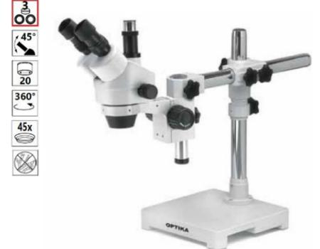
Stereomikroskop Trinokular mit einem überhängenden Stativ komplett mit Kopfhaltung und Fokussiersystem für größere Proben. Leichte horizontale und vertikale Bewegung. Eine externe Beleuchtung wird benötigt.
