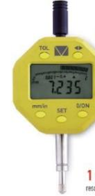
Messschraube mit 0,001mm Auflösung. Display mit digital und/oder analoger Anzeige. Funktionen (TOL, MAX/MIN, RANGE, DATA, ZERO, etc.). Messkraft 1,2-2,0 N. Wireless und USB Datenausgang auf Windows, Android und iOS bis zu 10m. Alle technischen Daten finden Sie auf unserer Homepage.
