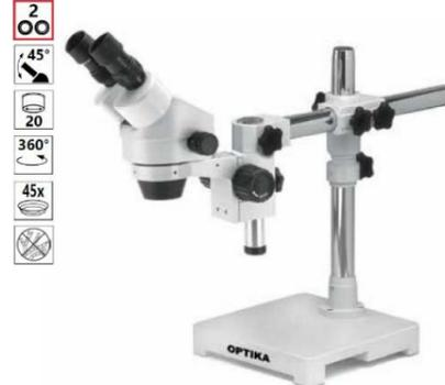
Stereomikroskop Binokular mit einem überhängenden Stativ komplett mit Kopfhaltung und Fokussiersystem für größere Proben. Leichte horizontale und vertikale Bewegung. Eine externe Beleuchtung wird benötigt.
