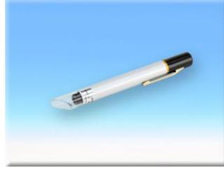
Die Serie 2036 gibt es wahlweise mit 25- und 50-facher Vergrößerung. Eine Teilung mit 0,05 bzw. 0,02 mm ist im Stiftmikroskop integriert. Die Fokussierung erfolgt durch das Aufsetzen des Mikroskops auf die abschraubbare Acrylspitze. Ein Schwenken um den Aufsetzpunkt fokussiert die Messstelle. Die
