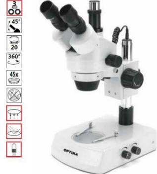
Stereomikroskop Trinokular mit einem Säulenstativ und Halogenbeleuchtung für Auf- und Durchlicht, frei aufstellbar.
