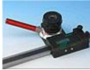
Resetaste der Nullpunkt der Messung festgelegt. Nach dem Verschieben des Schlittens zum zweiten Messpunkt kann das Ergebnis auf dem Display abgelesen werden. Das System besitzt eine RS232-Schnittstelle. So lassen sich die Werte seriell in den Computer senden. Zur Datenübermittlung steht ein RS232 kompatibles Interface-Kabel mit optischer Kopplung zur Verfügung oder alternativ ein Funkübertragungssystem.
