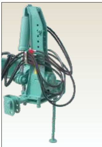
Portattrezzi con barra oscillante e/o testata fissa autobloccante durante il trasporto Oscillating headstock or fixed with mechanical locking system for transport purpose
