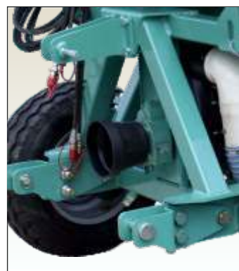
Comando meccanico per l'azionamento del ventilatore (versione portata)
