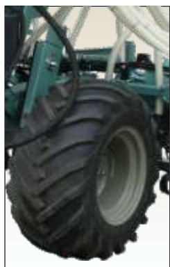
Sistema meccanico di regolazione della profondità della barra assolcatori (Versione portata). Ruote larghe e regolabili in larghezza.
