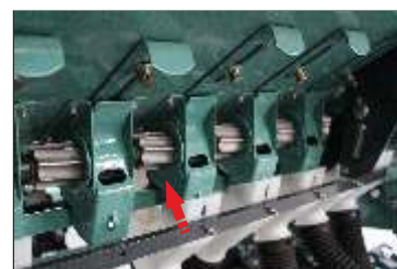
Distributori seme in acciaio inox - Stainless steel feed-cup - Distributeur graines de acier inoxydable - Distribuidor de semillas de acero inoxidable
