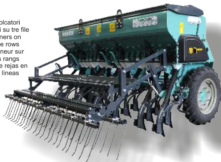
Pannello mobile per tramoggia seme/concime - Detachable seed/fertilizer hopper panel Panneaux mobiles pour trémie graines/engrais - Consola móvil para tolva semilla/fertilizante
