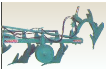
RA - Dispositivo di riduzione automatica per SI RA - Last bottom lifting up automatic device for hydraulic safety system RA - Dispositif escamotable automatique pour SI
