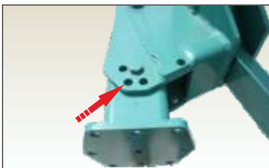
Posizioni per differenti largh. di lavoro Positions for different working width Positions pour différentes largeurs de travail
