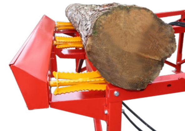
Holzlager mit 3 hydr. angetriebenen Rollen
