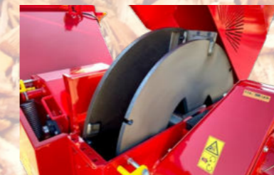
HARDOX - Schneidwerk leicht zugänglich
