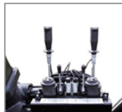
Kreuzhebelsteuerung 6-fach mechanisch 2-fach elektrisch
