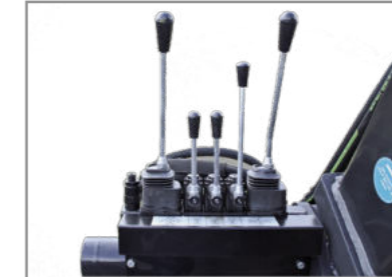
Kreuzhebelsteuerung 7-fach mechanisch
