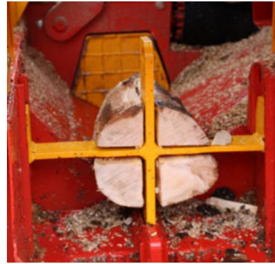
4-fach Spaltkreuz für gleichmäßige Holzseite
