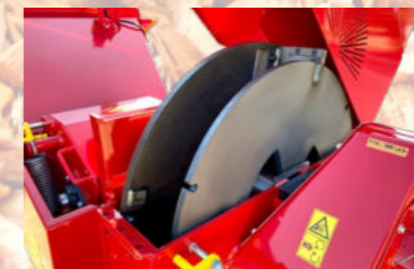
HARDOX - Schneidwerk leicht zugänglich
