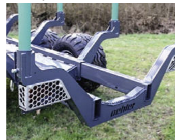
Beleuchtungsanlage mit Schutzgitter
