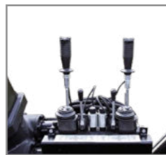
Kreuzhebelsteuerung 6-fach mechanisch 2-fach elektrisch
