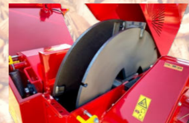
HARDOX - Schneidwerk leicht zugänglich
