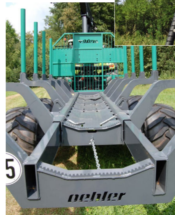
Stabiler und ausziehbarer Doppelrohrrahmen
