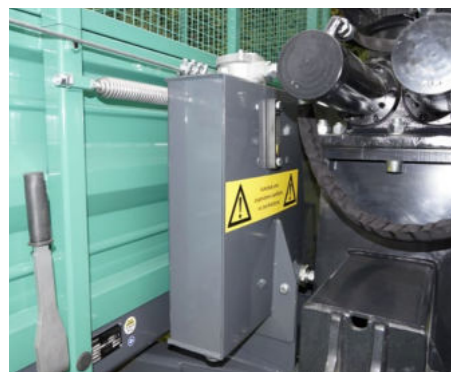
Tank eigene Ölversorgung
