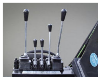
Kreuzhebelsteuerung 7-fach mechanisch
