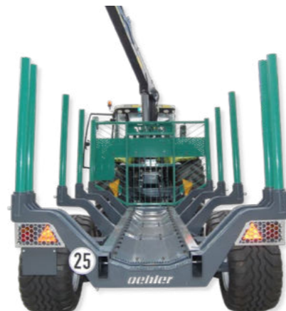
Kompakter stabiler Doppelrohrrahmen
