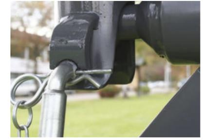
Kipplager mit Überkreuzstecksicherung
