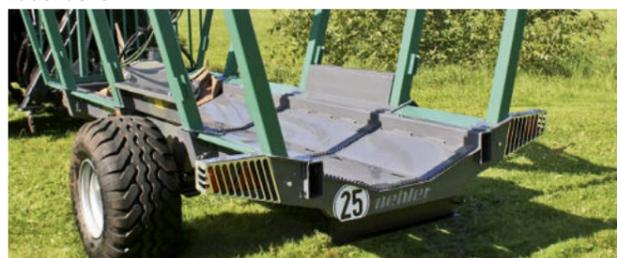
Einrohrrahmen mit verstellbaren Rungen
