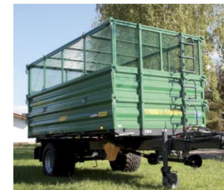
OL EDK 70 mit Laubaufsatz für Laubsauger
