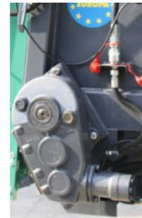
Getriebe + Danfoss-Ölmotor
