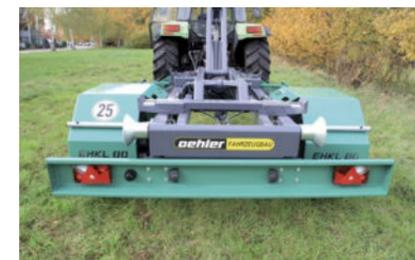
OL EHKL 80 Unterfahrerschutz mit Beleuchtungsanlage
