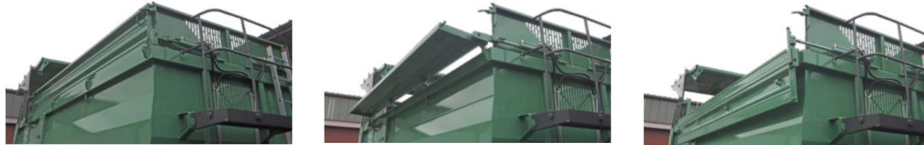
Hydraulisch abklappbarer Aufsatz
