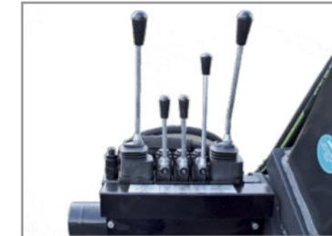
Kreuzhebelsteuerung 7-fach mechanisch
