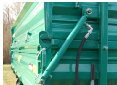
Hydraulisch verschließbare Bordwand
