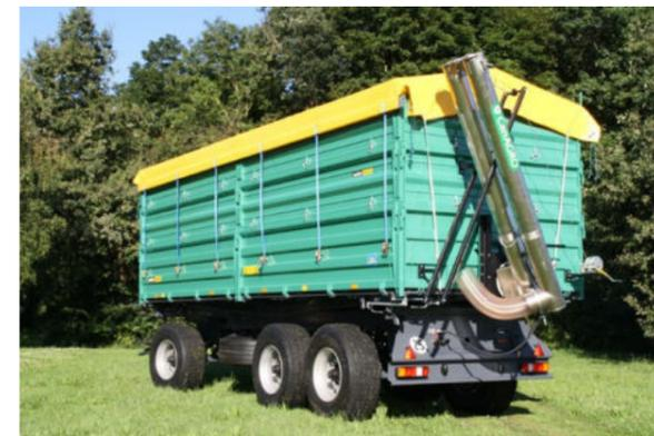
OL DDK 240 mit zusammengeklappter Kornschnecke
