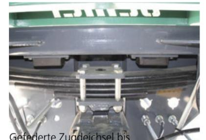
Gefederte Zugdeichsel bis max. 4t Stützlast
