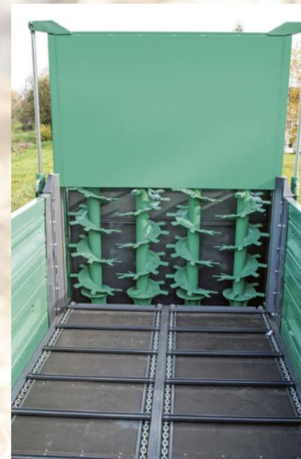
Kratzbodenleisten Hydraulischer Stauschieber
