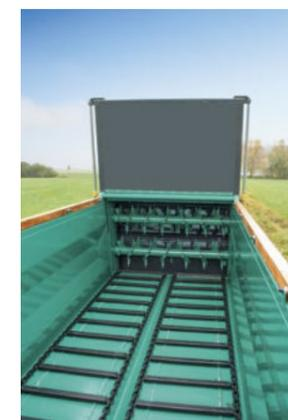
Kratzbodenleisten Hydraulischer Stauschieber
