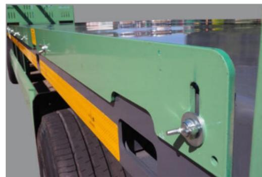
Verstellbare Sicherungsleiste für Großkistentransport
