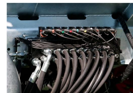
Hydraulischer Steuerblock/Profi Ventil
