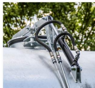
Hydraulischer Dohm 40mm ø
