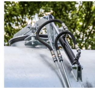
Hydraulischer Dohm 40mm ø
