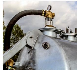
Überdruckventil und Manometer
