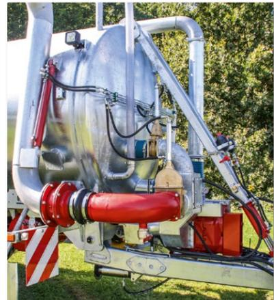
Andockvorrichtung 8" hydraulisch Ø 200 mm mit Trichter
