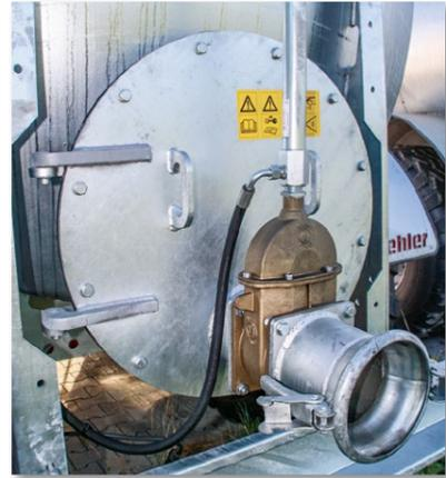
Hydraulische Schieberöffnung und Glockenschieber
