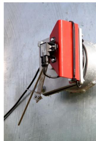
Füllstandsensor bei ISOBUS
