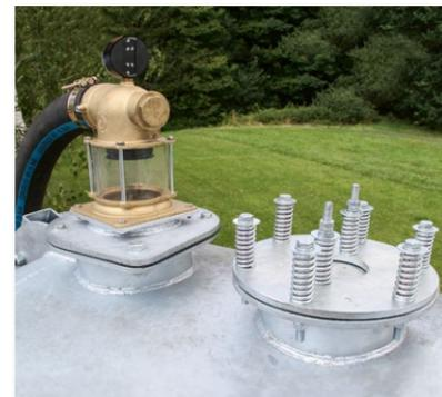
Dohm mit Sicherheitsventil + Unter-/Überdruckventil
