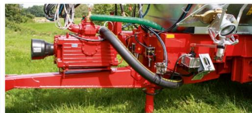
Kompressor mit gefederter Zugdeichsel
