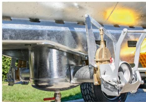
Tiefenentleerung für Andockvorrichtung mit Befüllsystem
