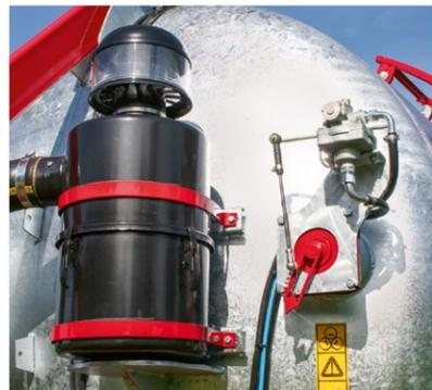
Schalldämpfer mit Ölabscheider
