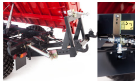
Porta-attrezzi posteriore idraulico con attacco a tre punti, removibile, adatto al trasporto di attrezzature ad esempio gru / caricatori forestali, verricelli, spacalegna, seghe...
