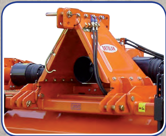
Telaio a tre punti di robusta fattezza con attacchi oscillanti nelle serie più professionali. - Strong frame three-point hitches with swinging hitches in the series more professional - Robuste attelage 3 points avec barre avant déportable dans la série plus professionnel - Stark Rahmen 3 Punkt-Anbau, schwingend Verbindung in der Serie professioneller.
